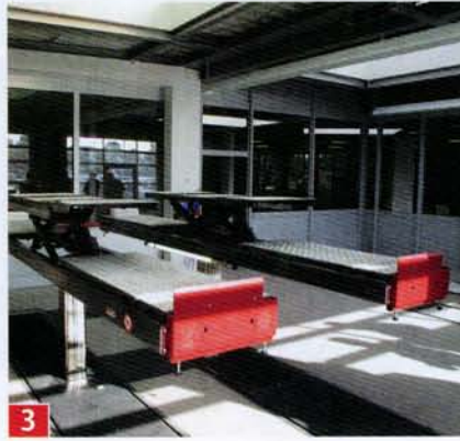
3 Zwei Spuren, davon eine mit MAHA-Prüfstand für die Serviceannahme sowie eine dritte Spur für die HU-Prüfung bilden die neue Verbindung zwischen Schauraum und Werkstatt.
